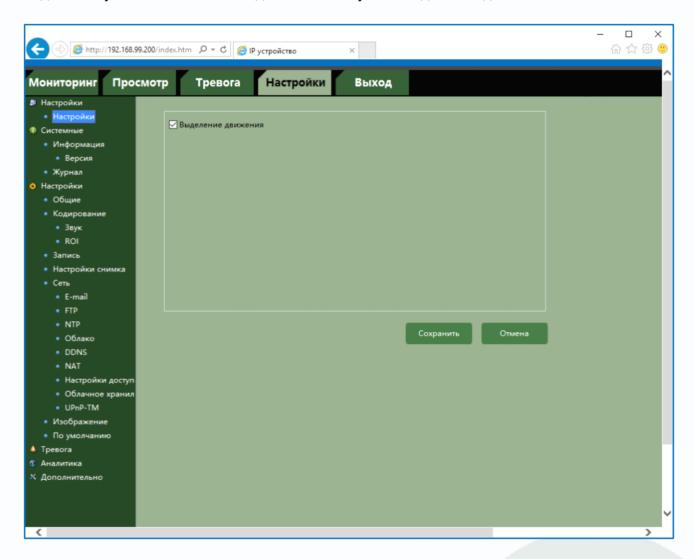
Если данный пункт активирован и в камере имеется встроенная видеоналитика, то при включенном детекторе движения и/или аналитических функциях, на изображение камеры будут накладываться линии, заданные в аналитических функциях, а также будет выделяться движение в поле зрения камеры. Пример показан ниже.
