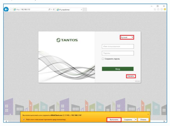
Нажмите кнопку **Скачать**. Сохраните или сразу же запустите на выполнение скачанный файл. Начнется установка программного обеспечения.
