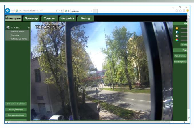
Выберите **Главный поток** или **Субпоток** для трансляции, и в браузере появится изображение, транслируемое камерой. При этом в центральной части находится изображение, получаемое с IP-видеокамеры, а в верхней части – основное меню настроек. Внизу и справа находятся кнопки управления дополнительными функциями.
