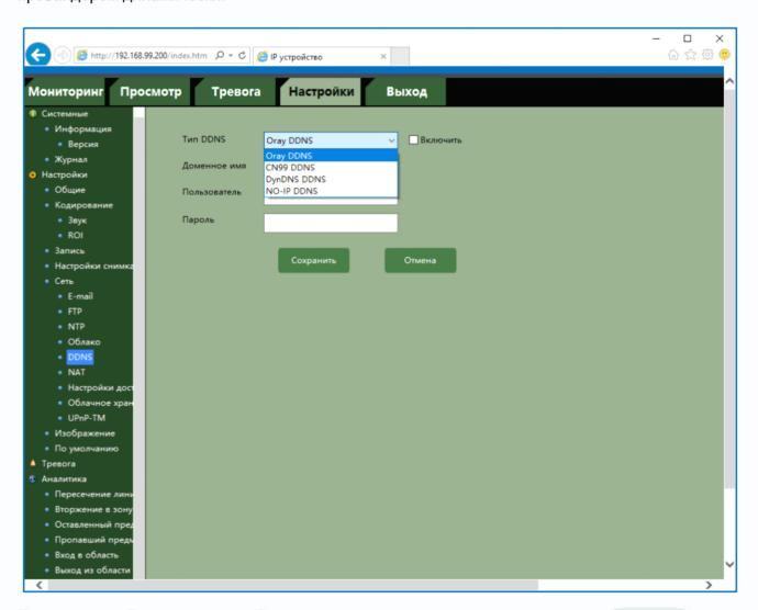
Примечание. В случае, если IP-адрес выдается компьютеру на определенное время, чаще всего лишь на один сеанс связи — такой адрес называют динамическим. В большинстве случаев для индивидуальных пользователей интернет — провайдеры выдают динамические IP-адреса. Однако, для того, чтобы можно было обратиться к оборудованию в любой момент, оно должен иметь постоянный адрес. С этой проблемой легко справляется служба Dynamic DNS (DDNS).
