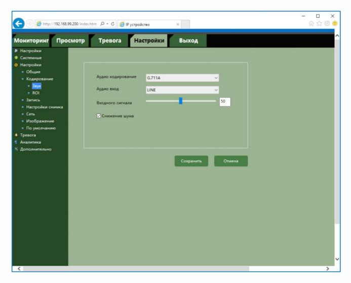
В меню Аудио кодирование выбирается тип кодека (пока доступен только G.711a).
