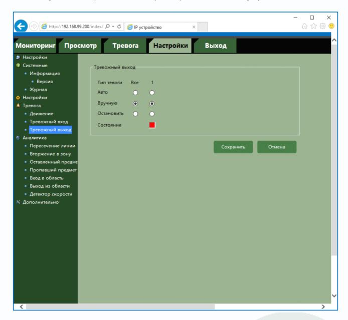
Можно установить работы тревожного выхода по расписанию, вручную или отключить тревожный выход, проверить его состояние.
