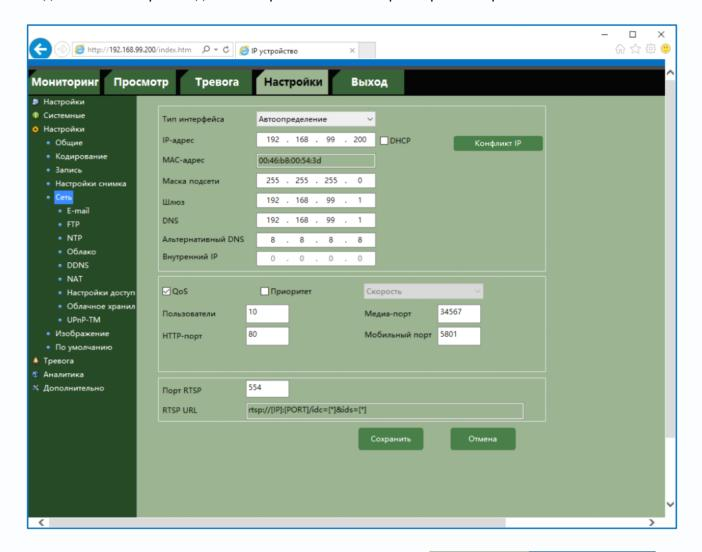
**Тип интерфейса** – скорость подключения камеры по Ethernet. 10/100 Мбит/с, дуплекс/полудуплекс.
