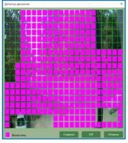
Зона, закрашенная фиолетовым цветом, используется для детектирования движения, в не закрашенной зоне детектирование движения не производится.
