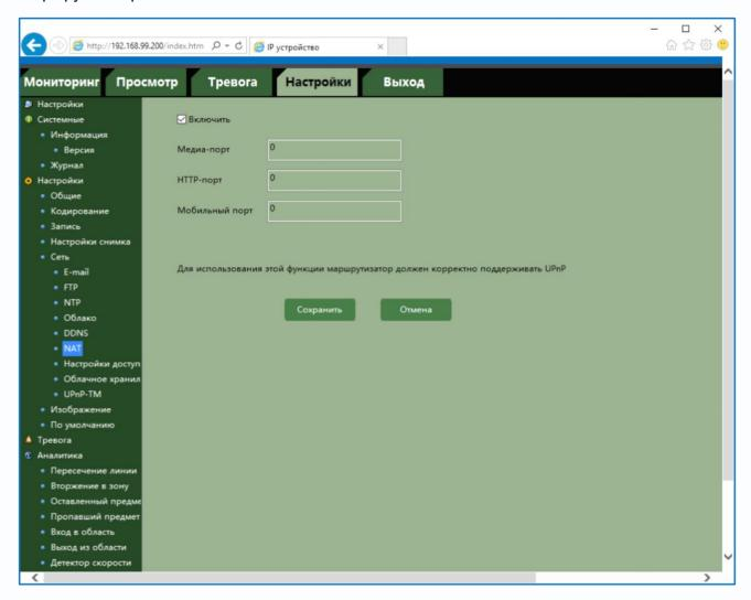
При поддержке роутером данной функции для того, чтобы обратиться к камере из Интернет (при условии, что сам маршрутизатор имеет выделенный статический IP адрес), достаточно просто включить в роутере поддержку UPnP, включить трансляцию портов через NAT в устройстве. При этом маршрутизатор сам будет транслировать через NAT обращение из Интернет к камере на соответствующие порты.
