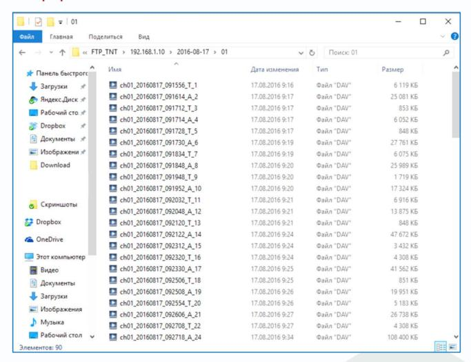
Камера записывает видеофайлы на FTP сервер в специфическом формате, совместимом с многоканальным форматом записи видеорегистраторов, поэтому для чтения файлов необходимо использовать ПО **TS VMS** или плеер из комплекта поставки камеры.
