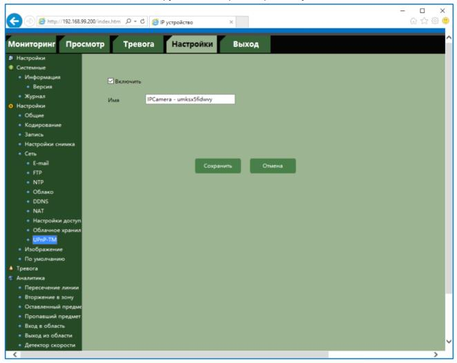
Технология UPnP (Universal Plug and Play) позволяет персональным компьютерам и интеллектуальным сетевым системам соединяться между собой автоматически и работать совместно через единую сеть. Платформа UPnP строится на основе таких интернет - стандартов, как TCP/IP, HTTP и XML. Поддержка UPnP реализована в операционных системах Windows.
